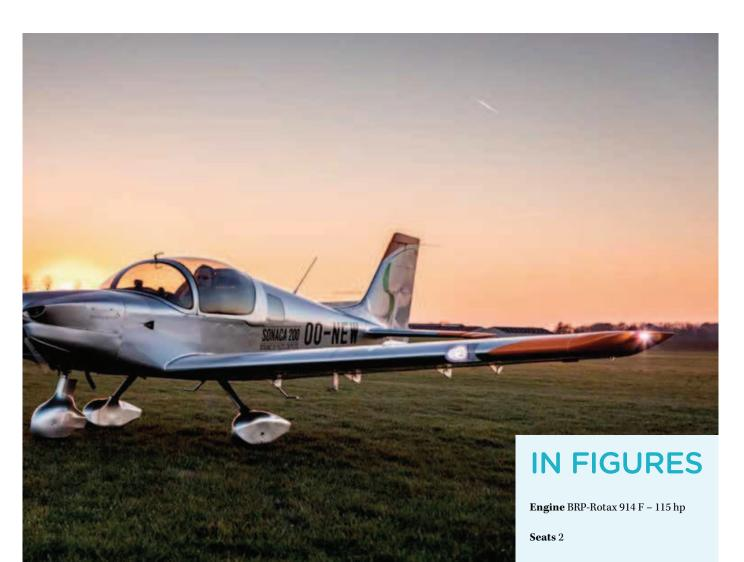
$\label{eq:Dimensions} \textbf{Dimensions} \ \text{Wing span 9.15m,} \\ length \ 7m$
