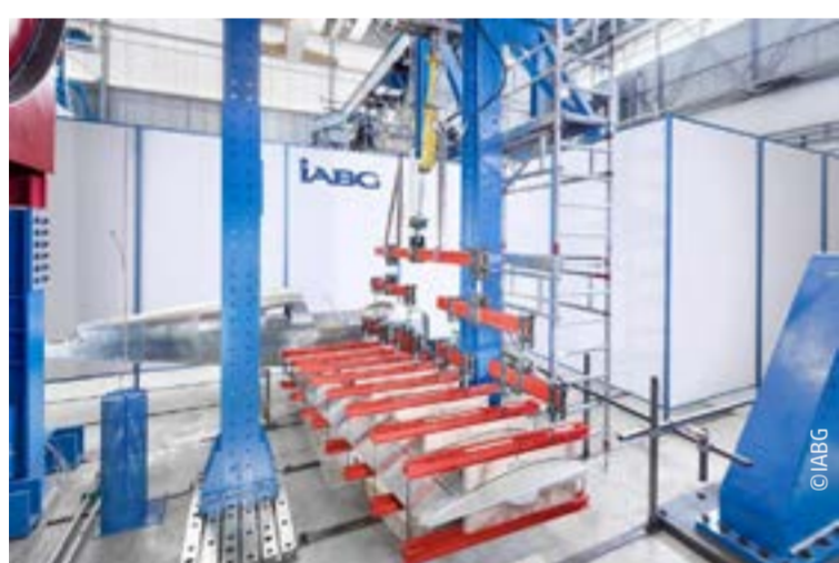
L'aile du Sonaca 200 sur son banc d'essai pour un chargement limite, ultime et à rupture.
